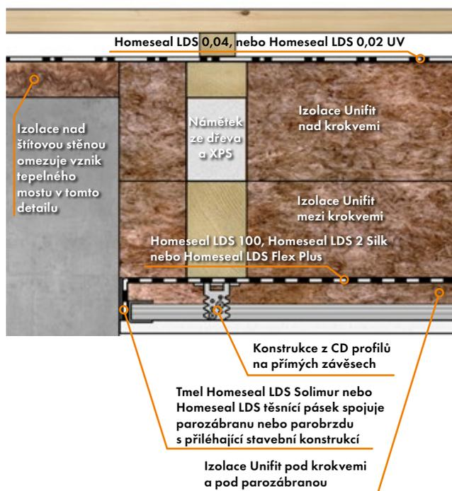
V některých případech může být vhodné kombinovat zateplení nad krokvemi, mezi krokvemi a pod krokvemi. Toto řešení umožňuje dosáhnout špičkové výsledné hodnoty součinitele prostupu tepla, a zároveň zajistit maximální vzduchotěsnost na úrovni vnitřní vzduchotěsné vrstvy (parozábrany nebo parobrzdou).
