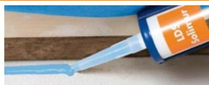
Trvale elastický tmel na parozábrany. Je určen k vytváření vzduchotěsných spojů fólií systému LDS s nehomogenními soudržnými podklady (omítky, betony, dřevo, zdící prvky atd.).
