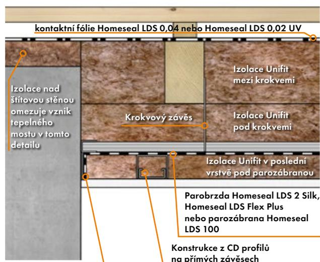
Tmel Homeseal LDS Solimur nebo Homeseal LDS těsnící pásek spojuje parozábranu nebo parobrzdou s přílehlající stavební konstrukcí
