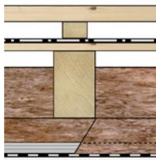
Tříplášťová skladba šikmé střechy - pokud je použita difúzně uzavřená doplňková hydroizolace nebo bednění z difúzně uzavřených desek například OSB je pod touto vrstvou nutno vytvořit účinně větranou vzduchovou vrstvu.
