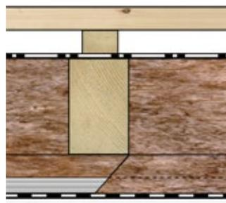
Dvouplášťová skladba šikmé střechy s difúzně otevřenou pojistnou hydroizolací.
